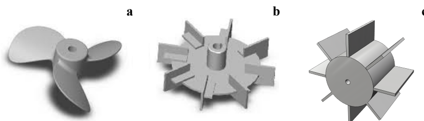
Figura 12. Geometrias das hélices usadas: agitador tipo a hélice (agitação axial), agitador tipo b Rushton (agitação radial), no reator vertical e c Roda de pás no reator “raceway”.
