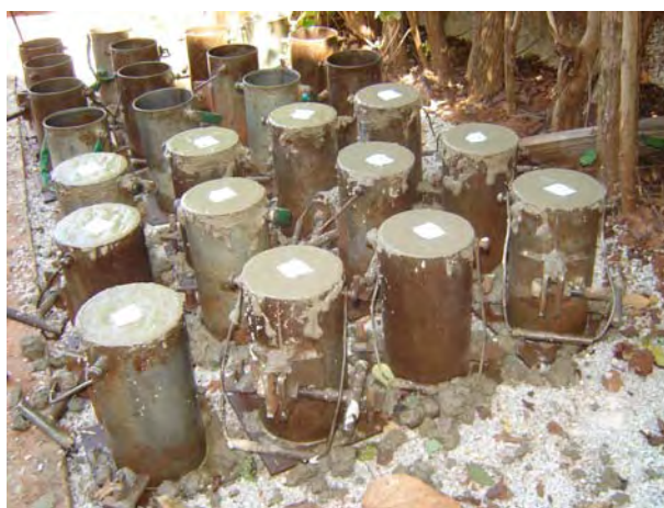
Figura 23. Corpos-de-prova moldados e identificados nas formas
