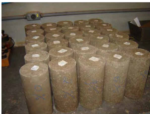
Figura 24. Corpos-de-prova sem as formas
