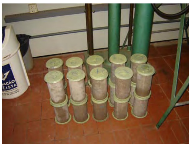
Figura 26. Corpos-de-prova capeados em suas faces com enxofre
