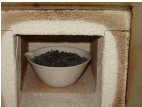
Figura 11. Mufla com temperatura de 150°C, para a secagem do lodo
