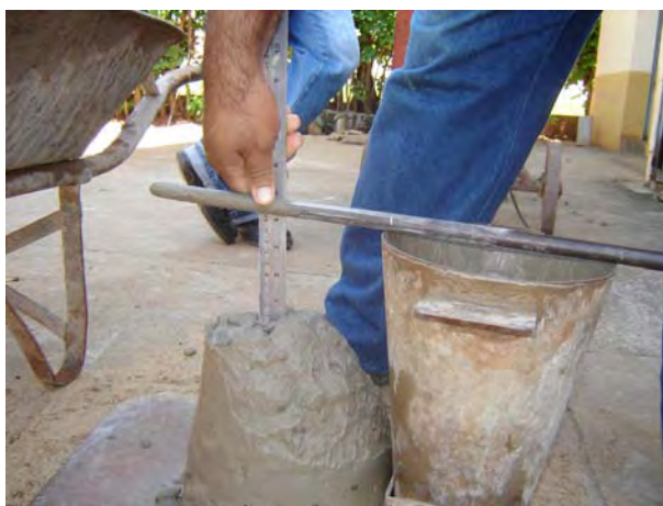
Figura 22. Verificação do abatimento do tronco de cone “slump” do concreto com 2% de resíduo
