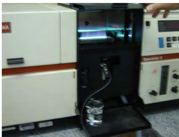
Figura 15. Chama do espectrofotômetro que atravessa o elemento a ser identificado
