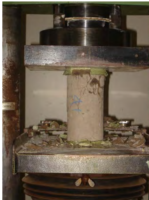
Figura 28. Ensaio de resistência à compressão axial
