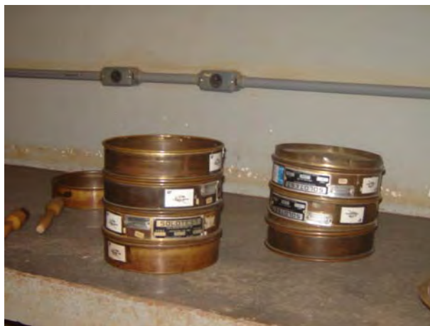
Figura 16. Peneiras utilizadas para o ensaio de granulometria
