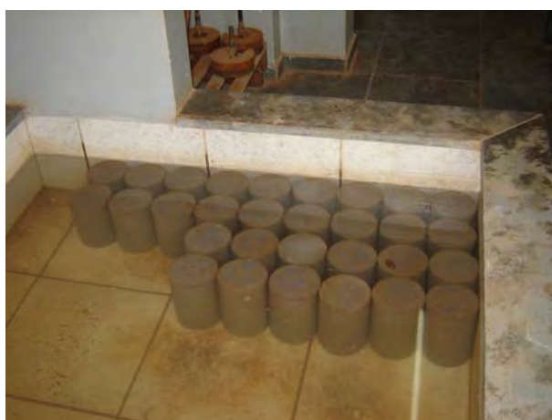
Figura 25. Corpos-de-prova submetidos à cura, submersos em água para hidratação
