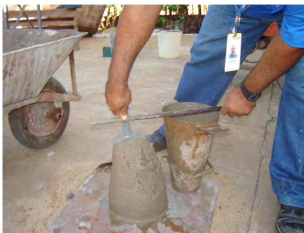
Figura 21. Verificação do abatimento do tronco de cone “slump” do concreto com 0% de resíduo
