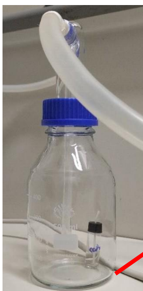
Figura 4 – Frasco tipo Drechsel com capacidade de 500 ml conectado ao fluxo de ar e acoplado na entrada de odor do túnel de vento. Seta vermelha: liberador.
