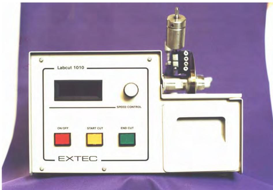
FIGURA 13 – Cortadeira – Labcut – para secção dos dentes
