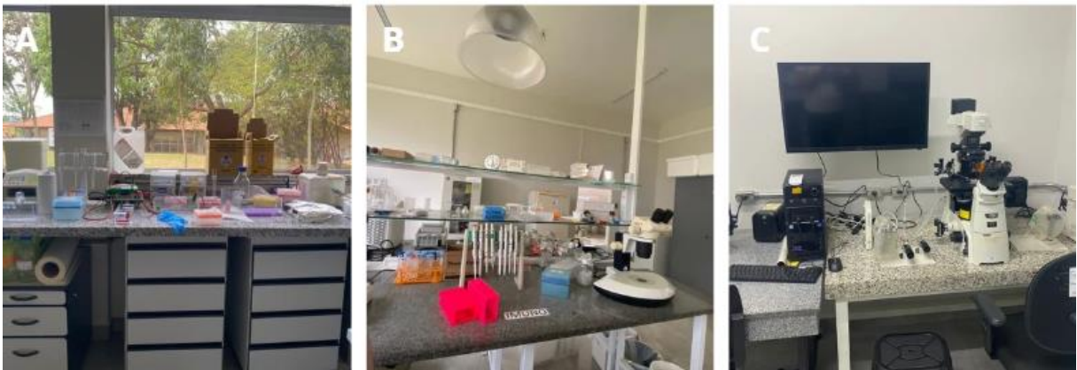
Figura 3: Estrutura pertencente ao laboratório do Anexo II, unidade do LMMD. A. Bancada de eletroforese. B. Bancada de imunohistoquímica. C. Microscópio micromanipulador para técnicas de transferência nuclear. Fonte: Arquivo pessoal (2025).
