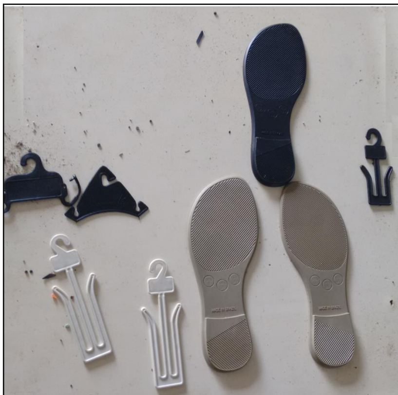
Figura 18 – Produtos injetados pela empresa C.
