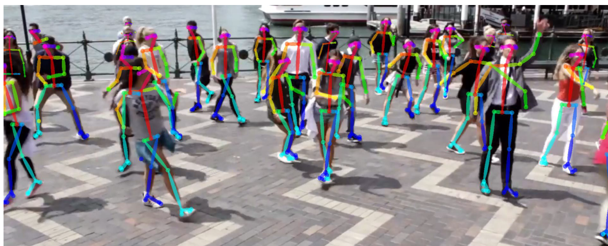
Figura 2 – Exemplo de aplicação do OpenPose, um método bottom-up de estimação de poses 2D com múltiplas pessoas.
