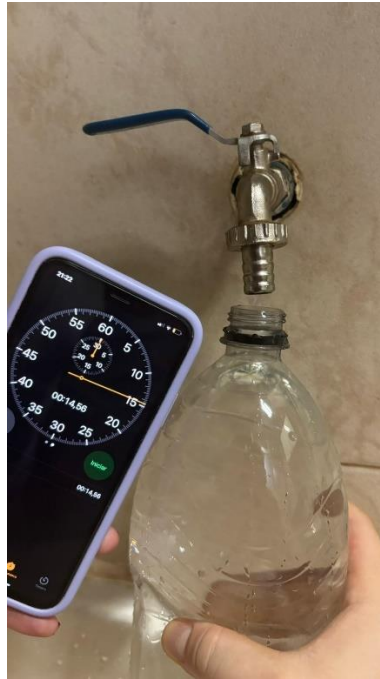
Figura 6 - Ensaio realizado para medição da vazão na mangueira.
