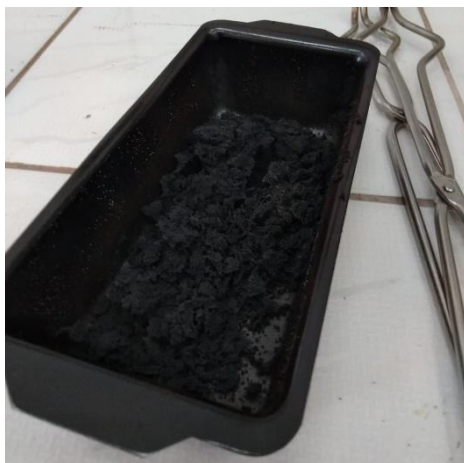
Figura 5 - Resultado da pré-queima do cobre.
