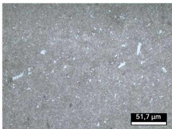
Figura 6 - Microestrutura do aço ferramenta do tipo H42 (UNS T20842) ASTM A681 – 08.
