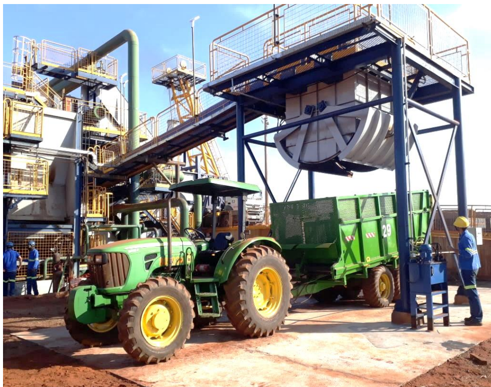
Figura 23 – Carregamento de impurezas minerais oriundas do sistema de limpeza a seco na Vale do Paraná S/A Álcool e Açúcar
