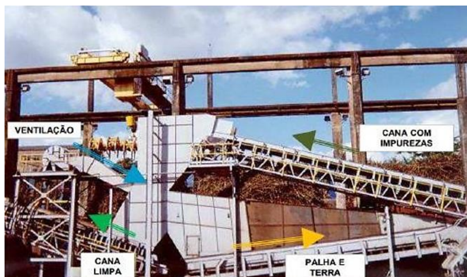
Figura 21 – Esquema de limpeza de cana à seco em usinas sucroenergéticas
