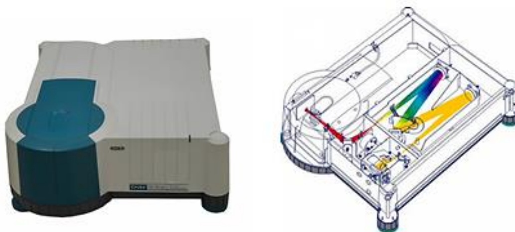
Figura 14 - Equipamento utilizado para medidas de absorção na região do UV-Vis. O lado direito representa a parte interna do espectrofotômetro.
