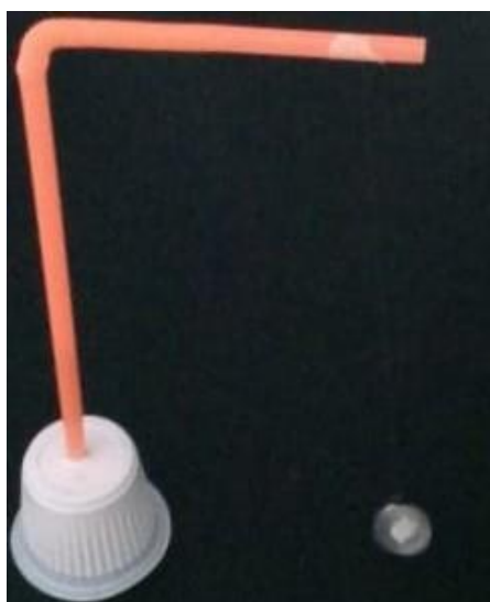
Figura 4 - Pêndulo Eletrostático Simples de baixo custo usado nas oficinas
