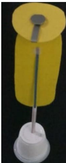
Figura 12 - Eletroscópio de baixo custo utilizado nas oficinas
