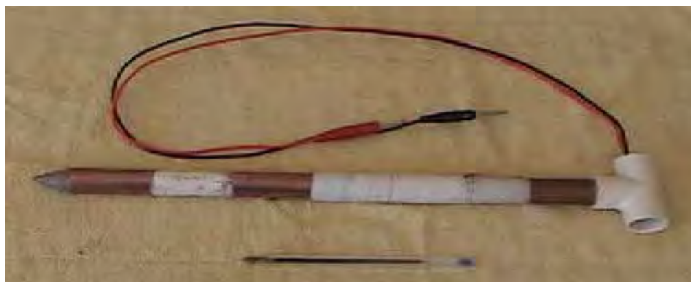
Figura 8. Sensor de medidas elétricas
