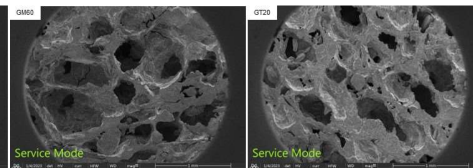
Figura 7. Micrografias eletrônicas de varredura em campo dos tratamentos GM60 e GT20. Área interna (aumento de 66 vezes).
