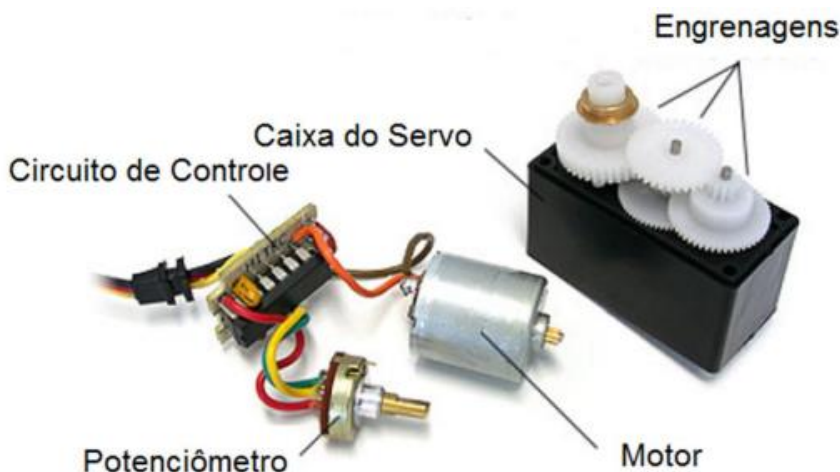
Figura 13 – Componentes internos de um servomotor.
