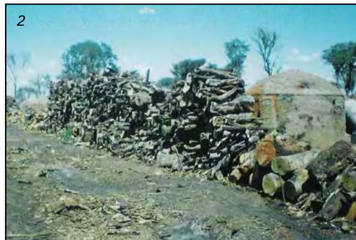
3) Alimentação do forno com lenha, sem os devidos cuidados com segurança e equipamentos de proteção.
