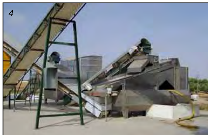
4) Esteira receptora de azeitonas para o início do processo de produção de azeite.
