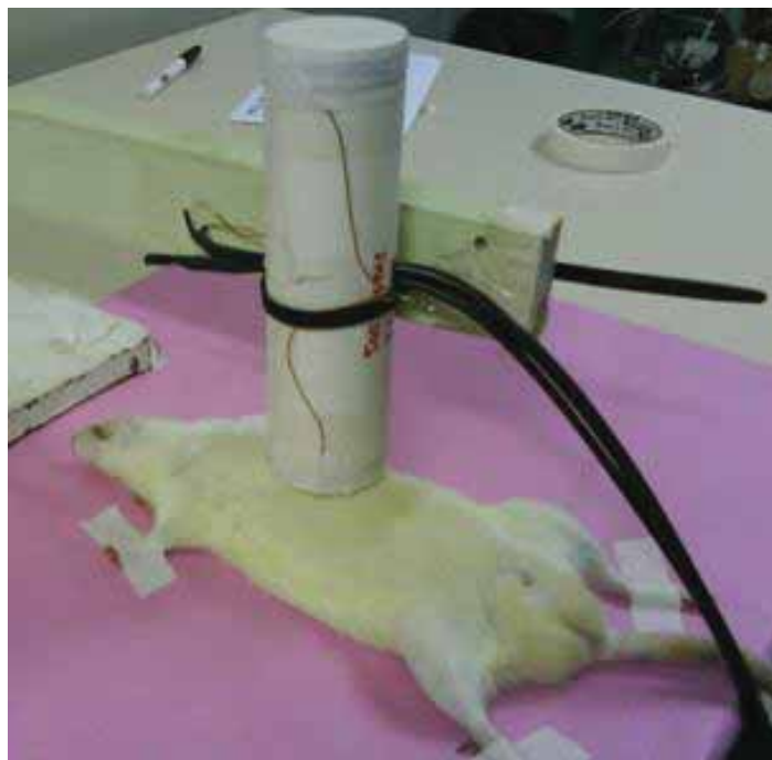
Figura 5: Posicionamento do sensor na avaliação de contração gástrica
