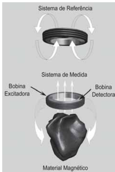
Figura 3: Diagrama esquemático mostrado o princípio de funcionamento da BAC.
