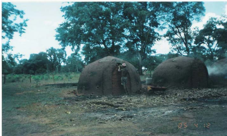
Figura 17: Trabalhador fechando a boca de forno, sem qualquer equipamento de segurança. Foto: Altamira Pereira, 2005.
