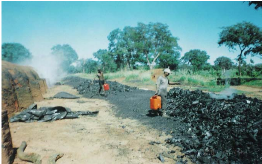
Figura 19: Trabalhadores resfriando o carvão recém tirado dos fornos, sem nenhum equipamento de segurança. Foto: Altamira Pereira, 2005.
