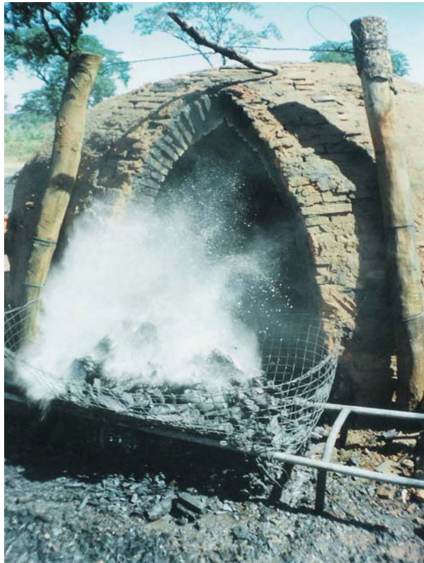
Figura 18: Carvão sendo retirado do forno, em alta temperatura, sem utilização de EPIs. Foto: Altamira Pereira, 2005.
