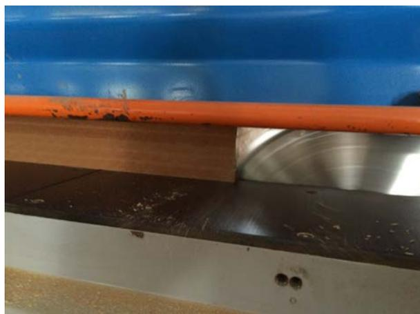
Figura 22: Cortes realizados simultaneamente em faixas resultantes do primeiro estágio
