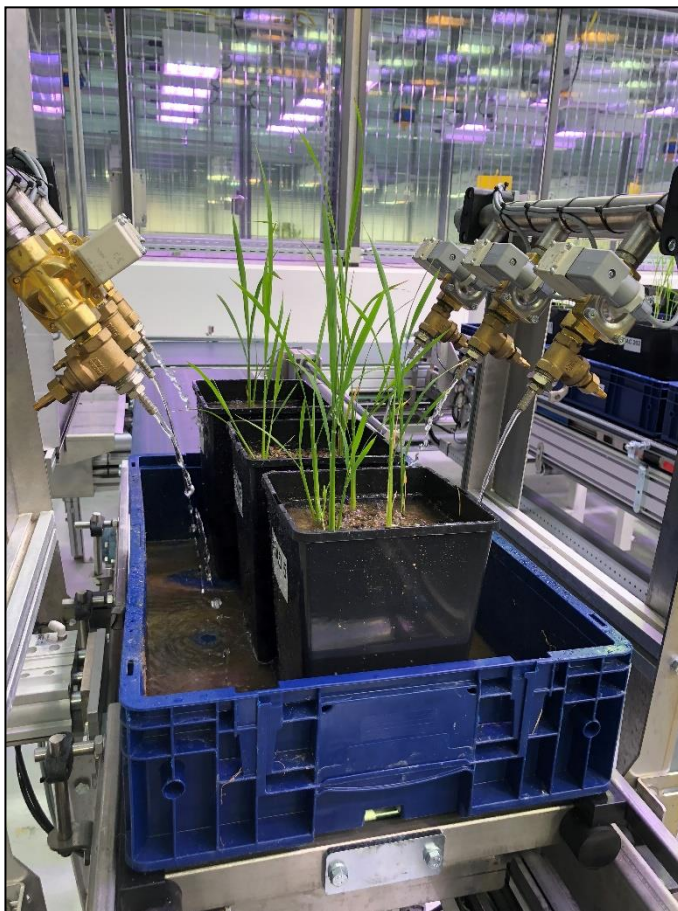
Figura 20: Sistema automatizado de irrigação.
