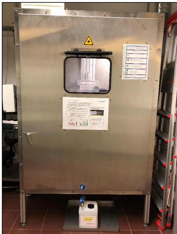
Figura 14 e 15: Equipamento de medição do tamanho das gotas e estimativa de deriva Spraytec Open Spray - MAL1082034.
