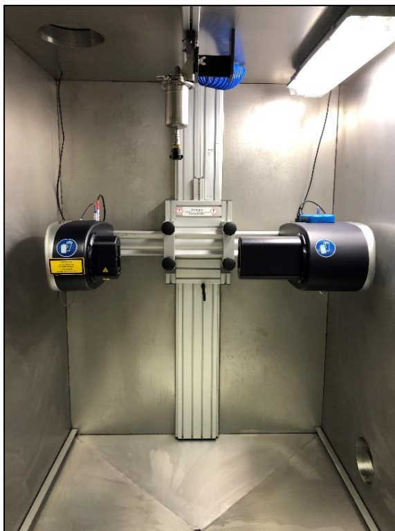
Figura 14 e 15: Equipamento de medição do tamanho das gotas e estimativa de deriva Spraytec Open Spray - MAL1082034.
