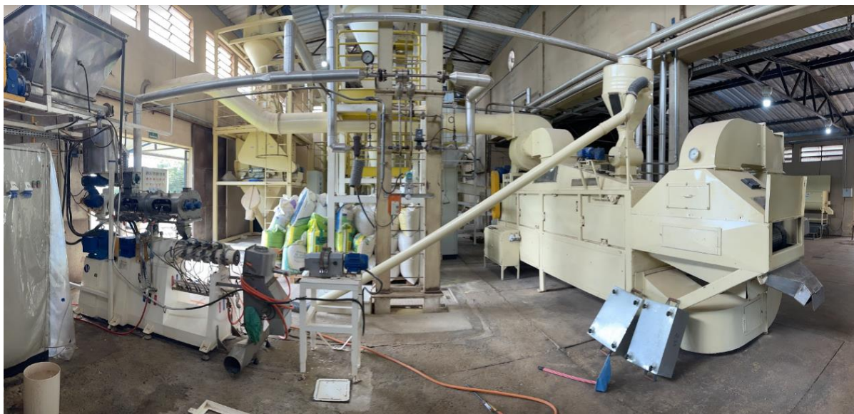
Figura 2. Etapas do processo de extrusão.
