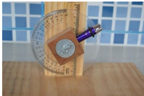
Fotografia 12 - Montagem do suporte do laser na coluna do teodolito
