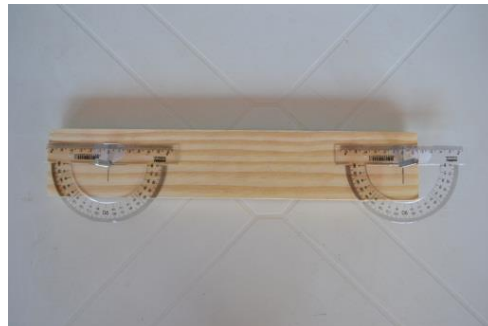
Fotografia 9 – Transferidores colados na coluna do teodolito
