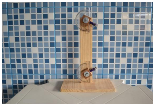
Figura 13 – Utilizando o teodolito para medir distâncias
