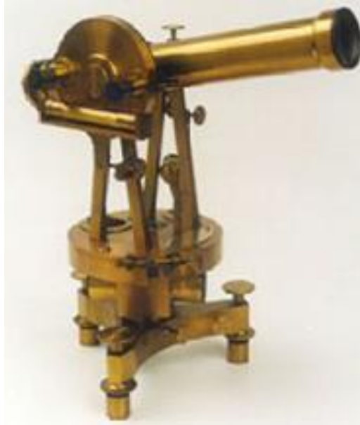
Figura 3 – Teodolito de Porro, também chamado de taquímetro de Porro.
