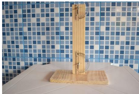
Fotografia 11 – Colagem da coluna do teodolito com a base
