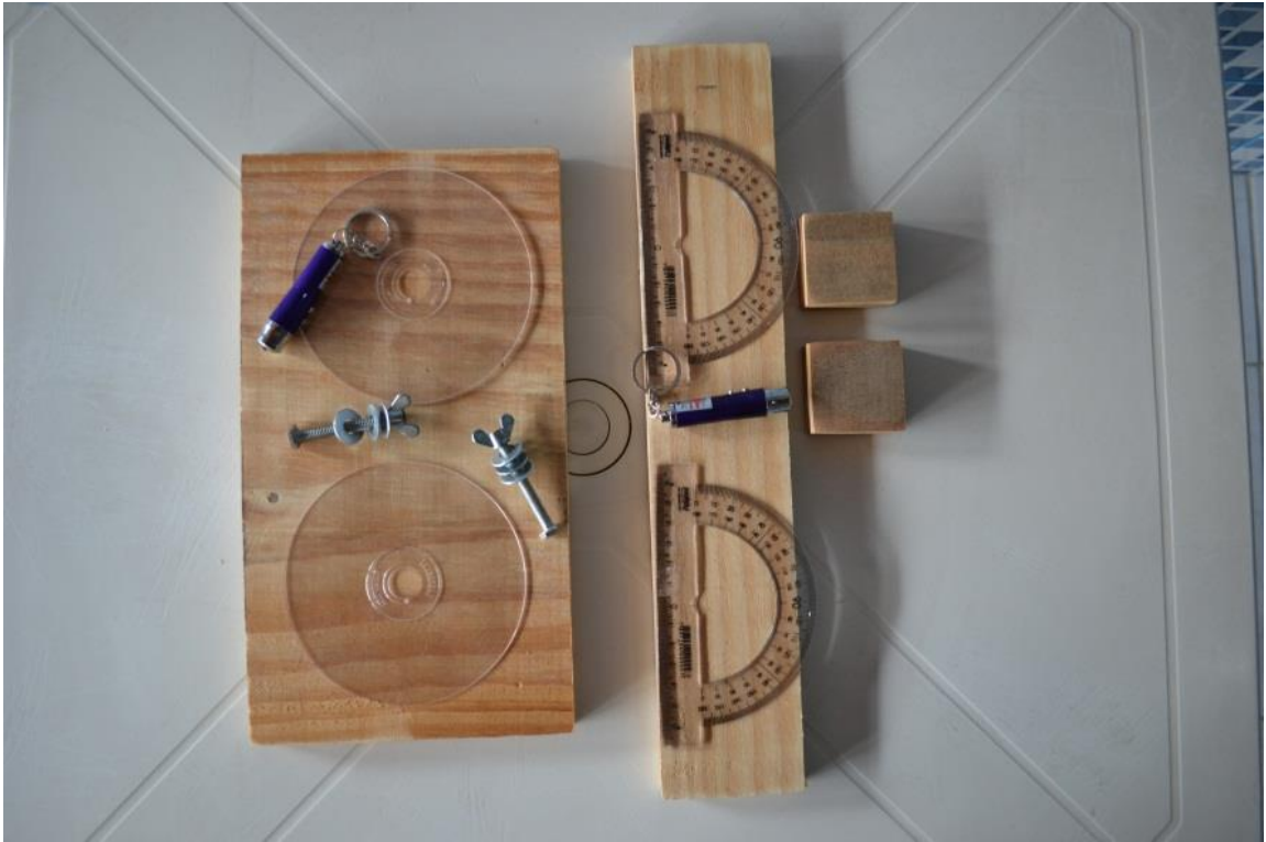
Fotografia 1 – Lista de materiais para a construção do teodolito experimental
