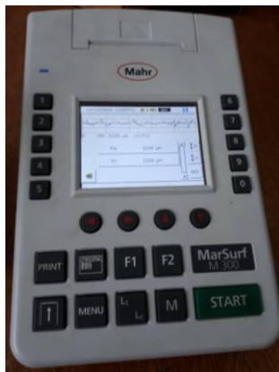
Figura 62 - Display com resultados de rugosidade
