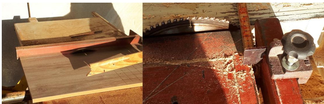
Figura 41 - Operação de corte da chapa de MDF
