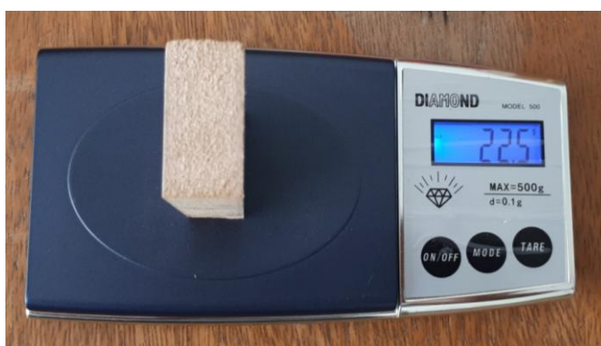
Figura 63 - Exemplo de pesagem realizada
