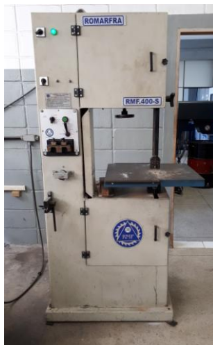
Figura 58 - Serra de fita vertical RMF.400-S
