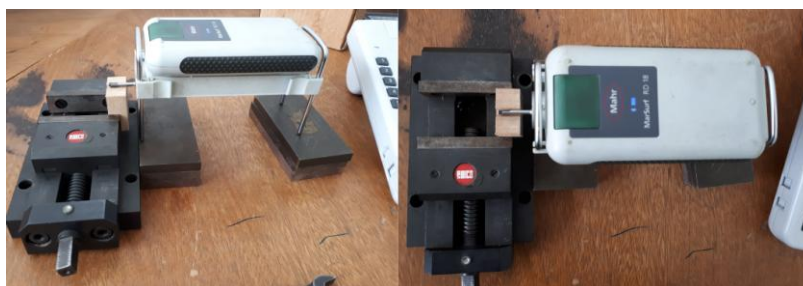
Figura 61 - Medição de rugosidade
