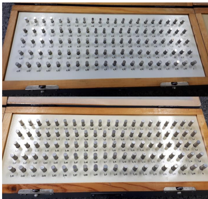
Figura 55 - Estojos de pinos padrão utilizados
