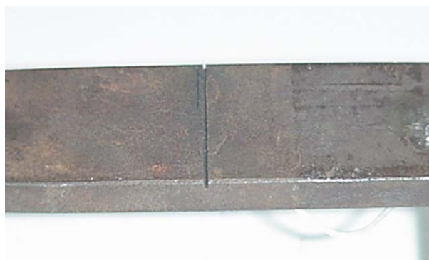
Figura 5.8 – Detalhe da falha introduzida.
