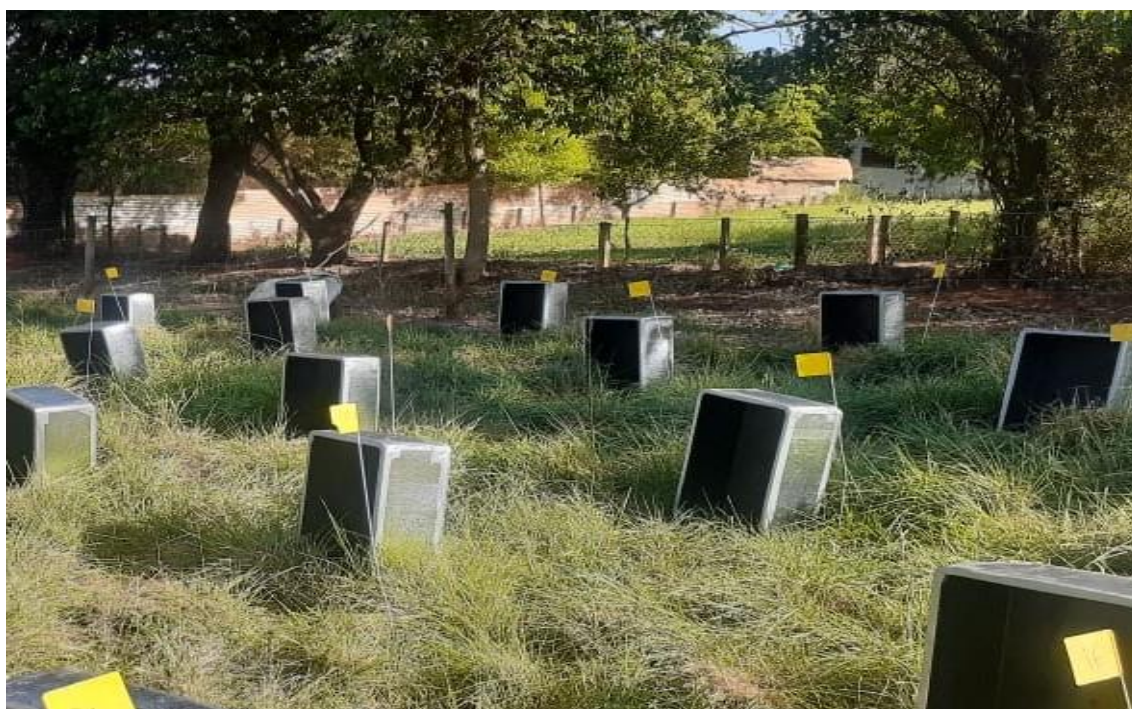
Figura 2- Câmaras estáticas abertas com dimensões 0,4 x 0,6 x 0,23 m, plástica, revestida com isolante térmico.
