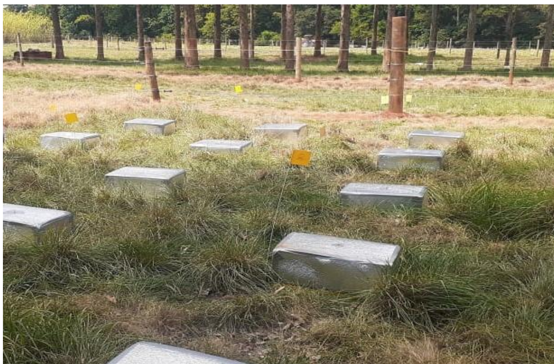
Figura 3- Câmaras estáticas fechadas para coleta de CH 4 ( \mu\text{g C-CH}_4 \text{ m}^{-2}\text{d}^{-1} ).
