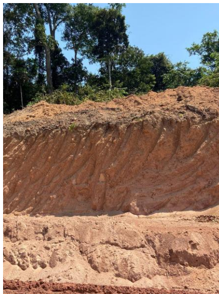
Figura 14: Perfil de Latossolo Amarelo sobreposto à formação arenítica Alter do Chão em um corte na PA-370 entre Mojuí dos Campos à Uruará/PA.
