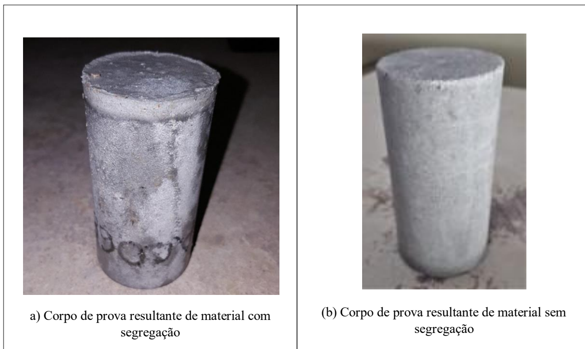
Figura 15 - Aspectos de corpos de prova moldados com misturas com e sem manifestação de segregação
