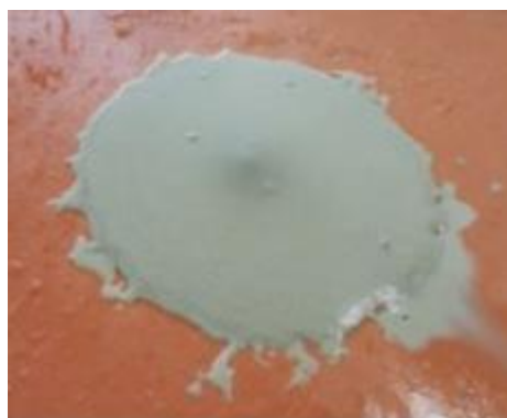
Figura 7 – Manifestação de segregação em superfície de espalhamento
