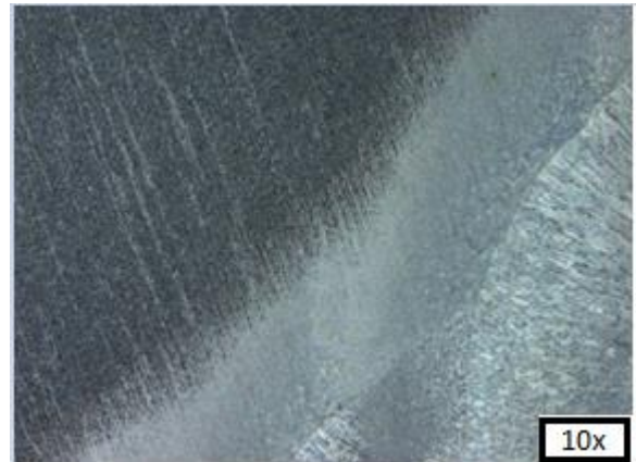
Figura 42 - Transição MB e junta soldada.
