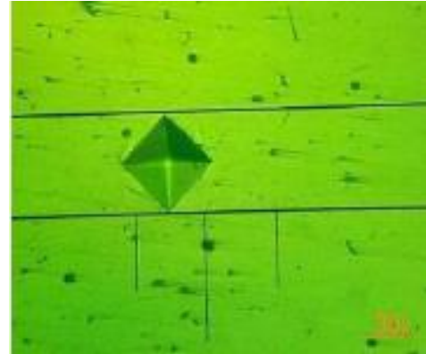
Figura 46 – Esquema do CDP e locais de ensaio Figura 47 – Microdureza Vickers. de microdureza Vickers.
