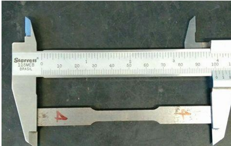
Figura 37 – Corpo de prova para ensaio de Tração.
