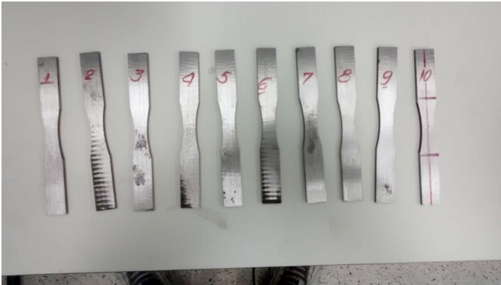
Figura 35 - Corpos de Prova para ensaio de Fadiga.
