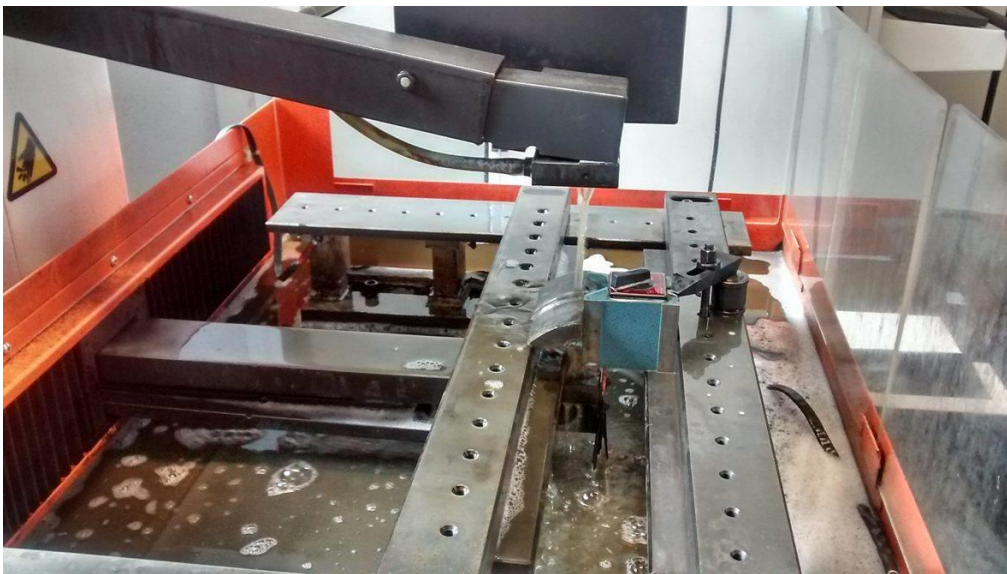
Figura 36 - Processo de corte por eletroerosão a fio.
