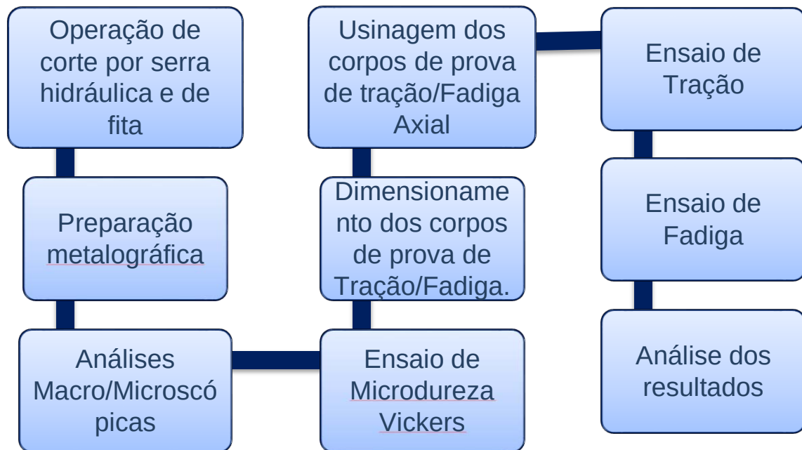
Figura 29 – Fluxograma das principais etapas realizadas na análise do aço.
