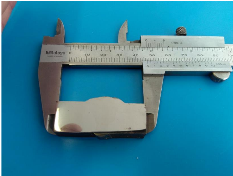
Figura 32 – Corpo de prova para análise metalográfica.
