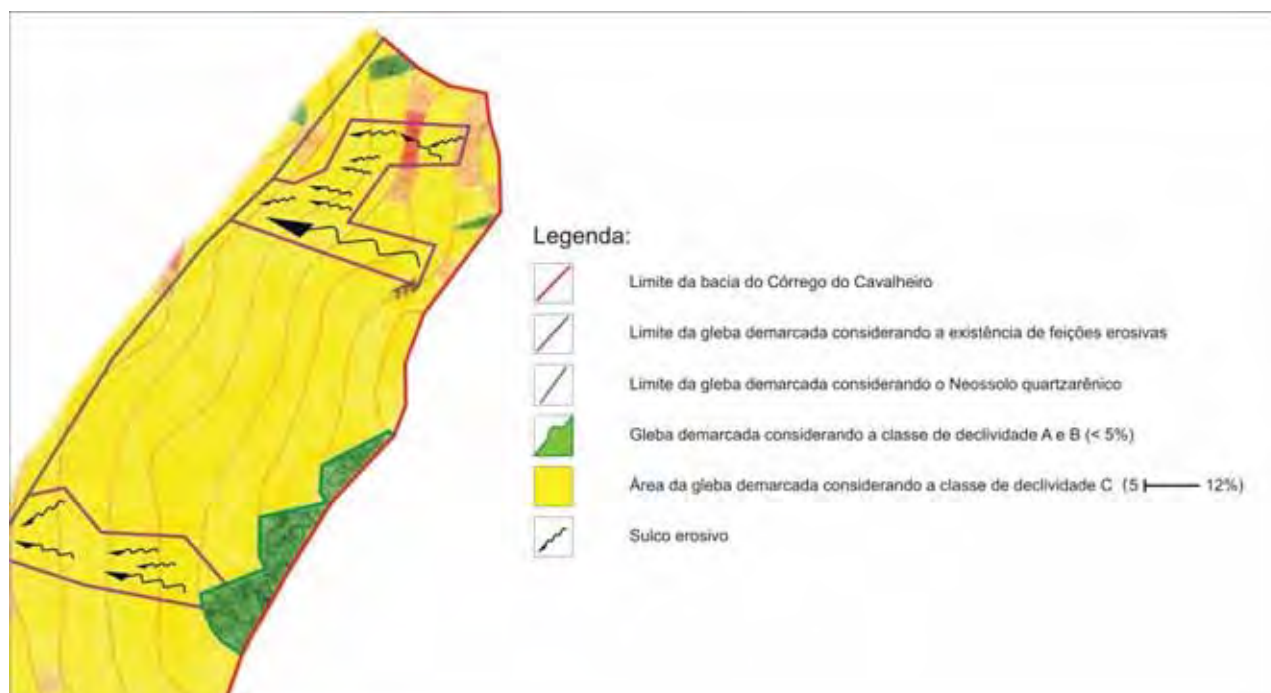
Figura 5 – Determinação das glebas, considerando os limites das classes de solos, das classes de declividade e das áreas contendo as feições dos diferentes estágios dos processos erosivos lineares.
