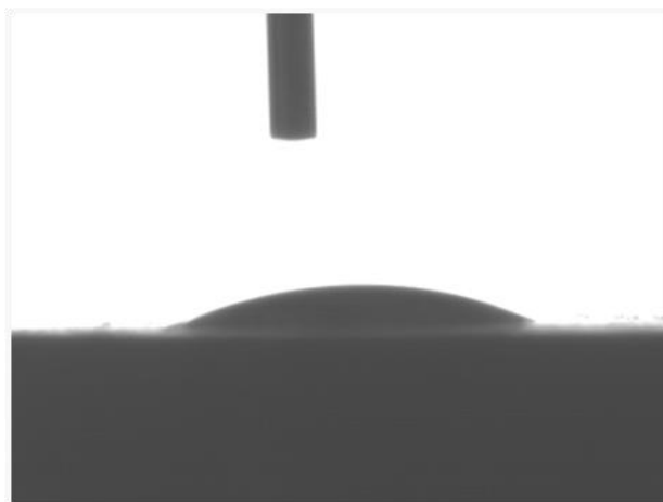
Figura 14 - Imagem da gota de água sobre espécime de Ti-30Ta: (Grupo II - Tratado)
