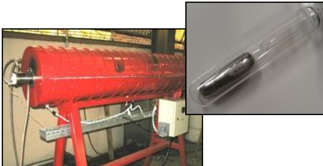
Figura 7 - Forno tubular empregado para homogeneização das ligas. Detalhe do lingote encapsulado a vácuo
