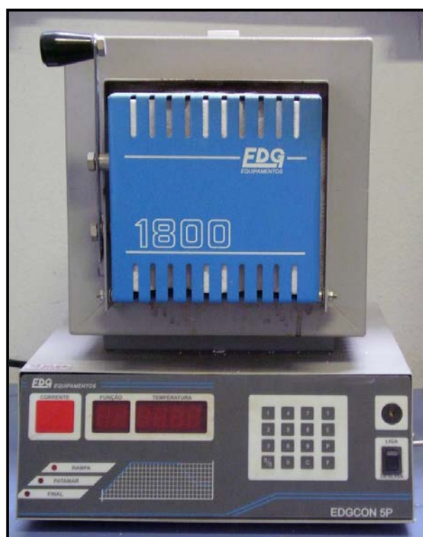
Figura 11 - Forno EDG com aquecimento por resistência elétrica.
