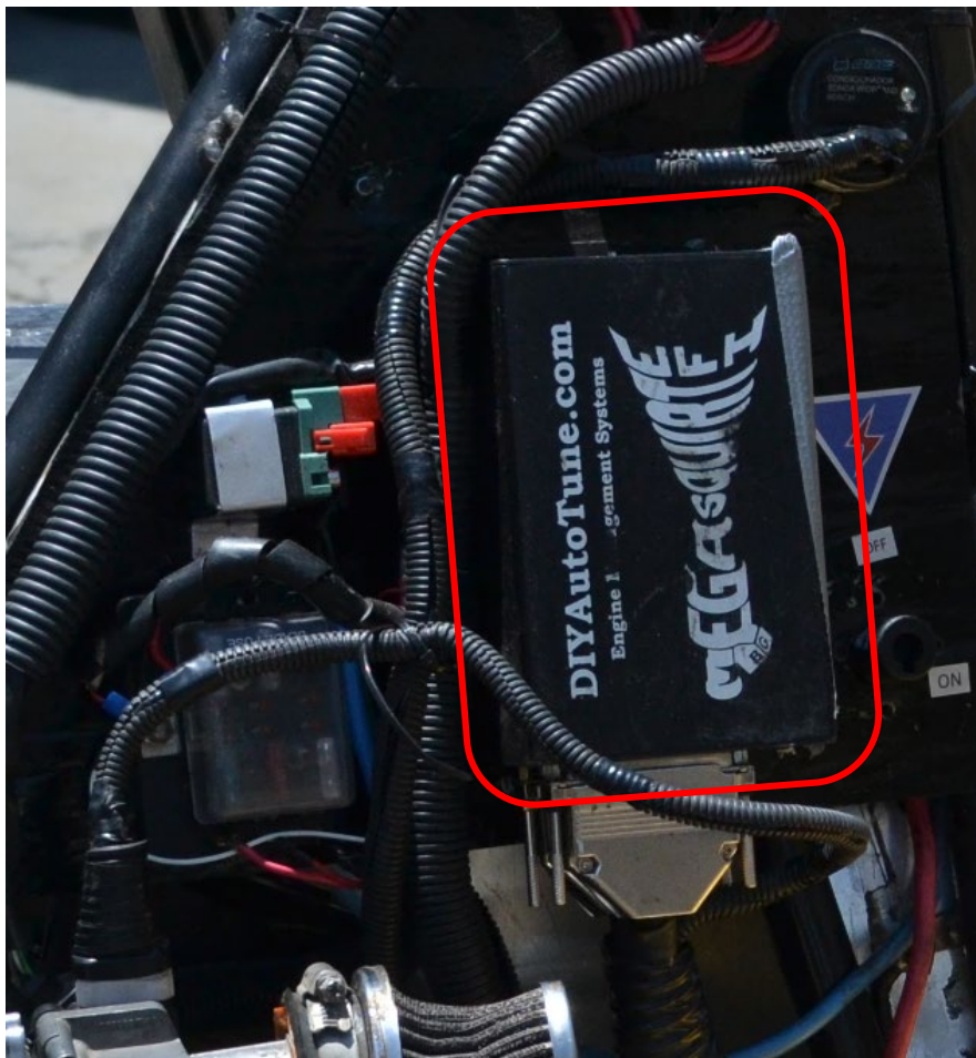
Figura 9. Injeção eletrônica MegaSquirt MS3/MSX instalada no veículo FXX
