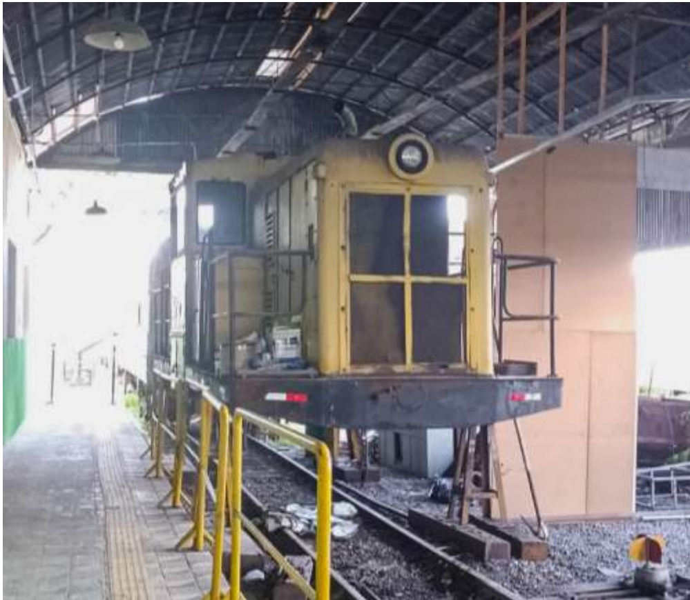
Figura 63: locomotiva pioneira diesel-elétrico em processo de restauração
