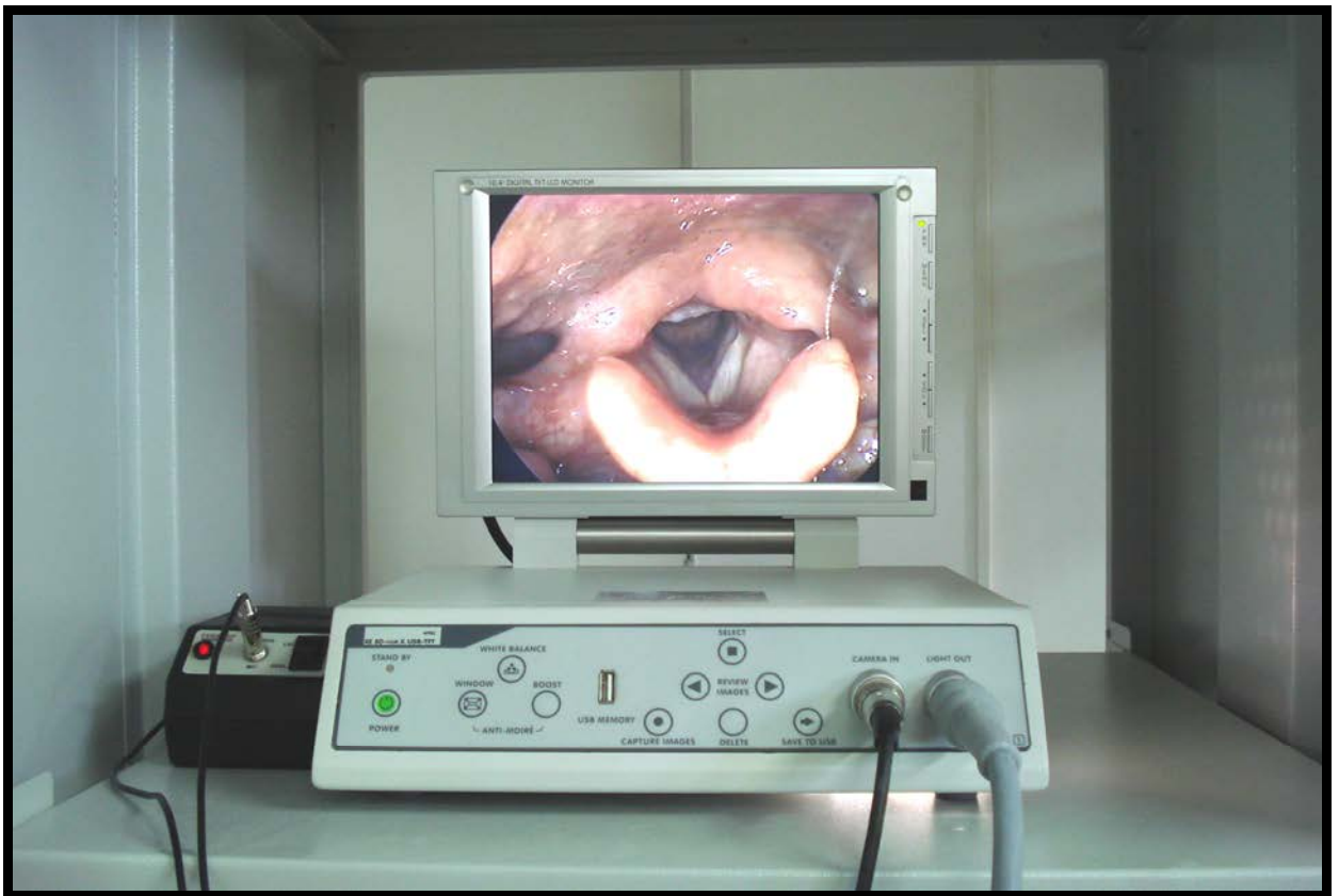
Figura 2- Sistema conjugado de captura de imagem de videolaringoscopia (sistema multifuncional video system type XE-30, Eco X -TFT/USB).
