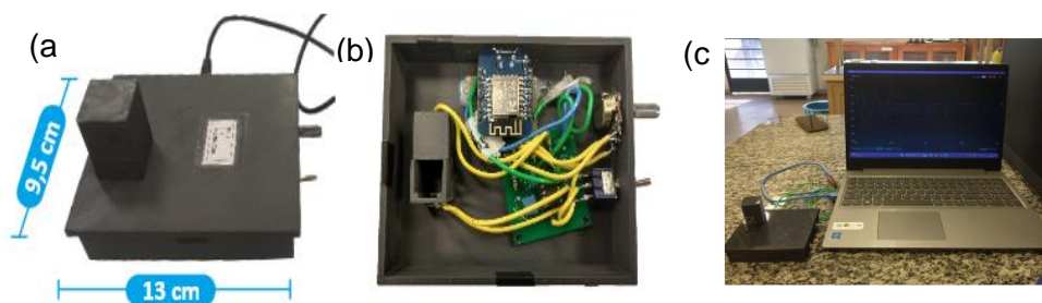
Figura 2. Fotografia do fotômetro 3D impresso, (a) vista superior (b) vista superior interna e (c) dispositivo em funcionamento.
