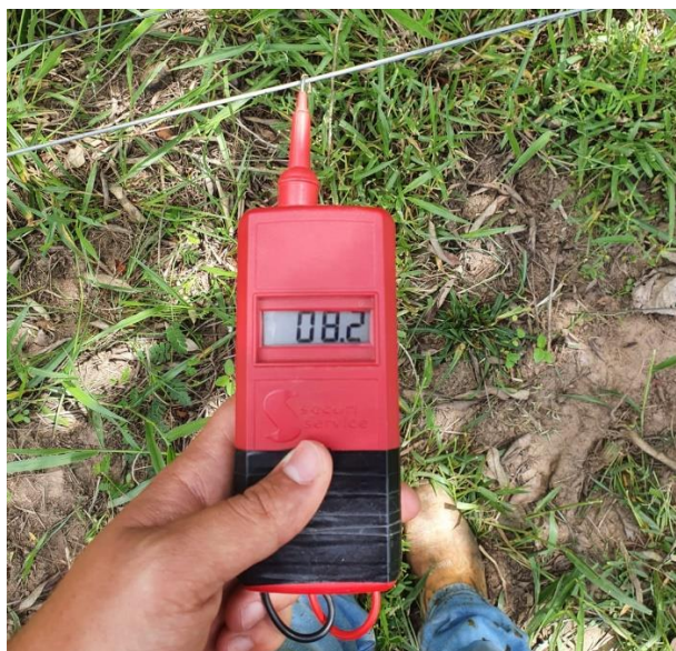
Figura 2: Medição de tensão de cerca elétrica.
