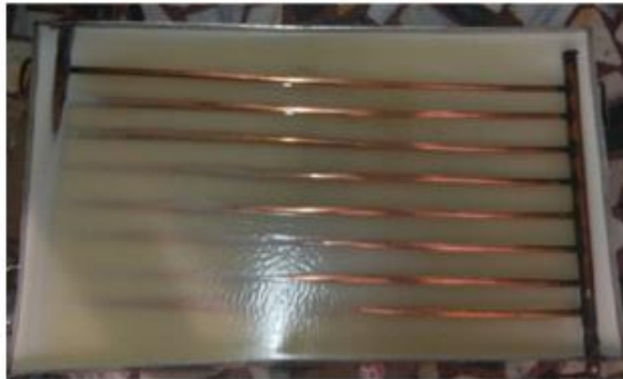
Figura 6 – Fotografia da vista de aletas de alumínio com material de mudança de fase (PCM).
