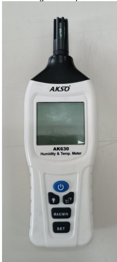
Figura 2. Termo-higrômetro portátil AKSO AK630
