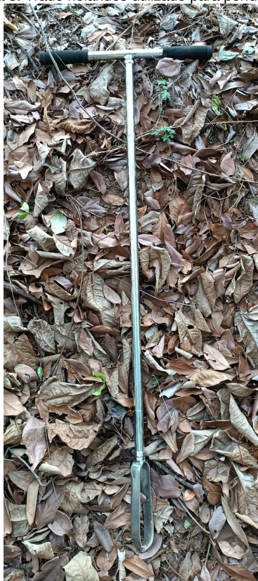
Figura 3. Trado holandês utilizado para perfurações.
