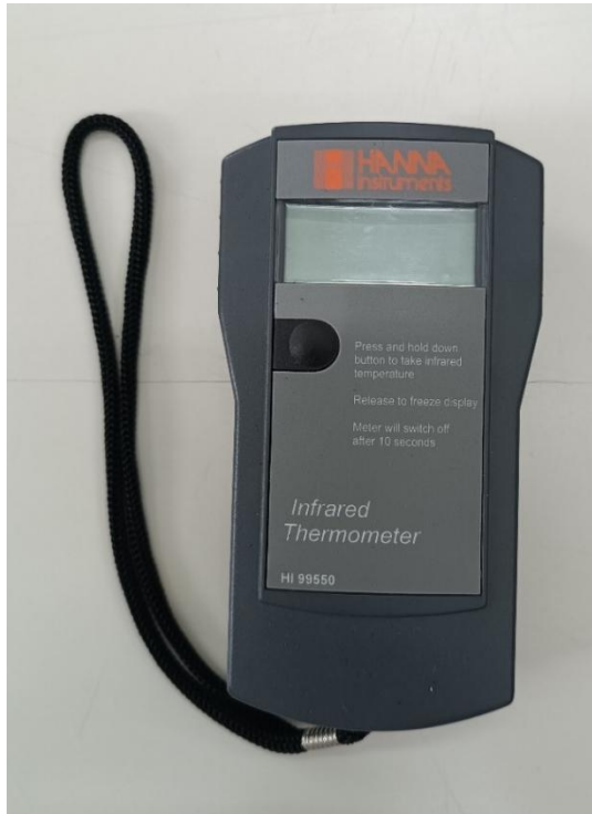
Figura 1. Termômetro infravermelho Hanna Instruments HI 99550.
