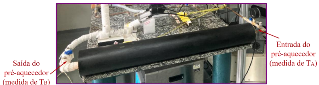
Figura 16 - Pré-aquecedor instalado na linha principal
