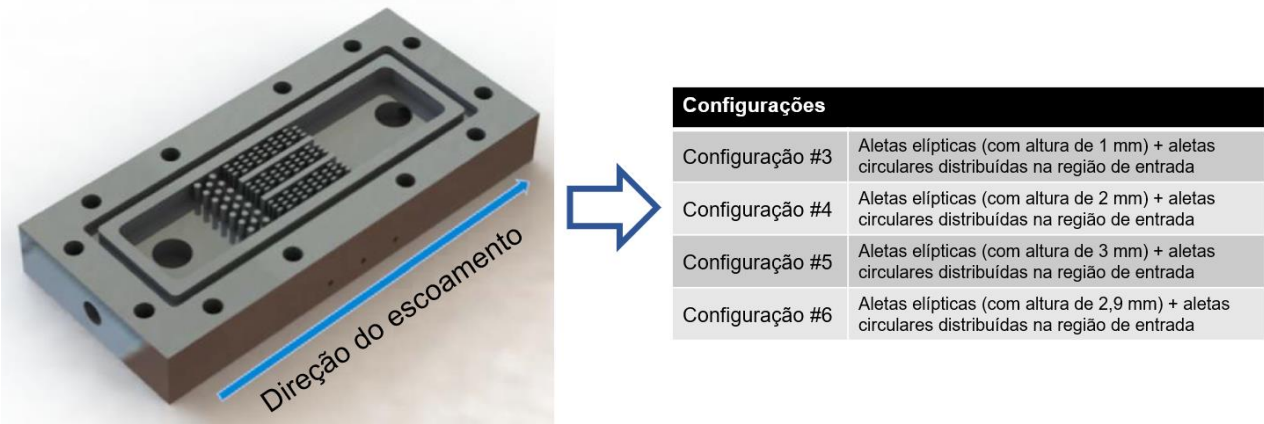
Figura 10 - Esquema ilustrativo das geometrias das microaletas testadas por Ateş et al. (2023)
