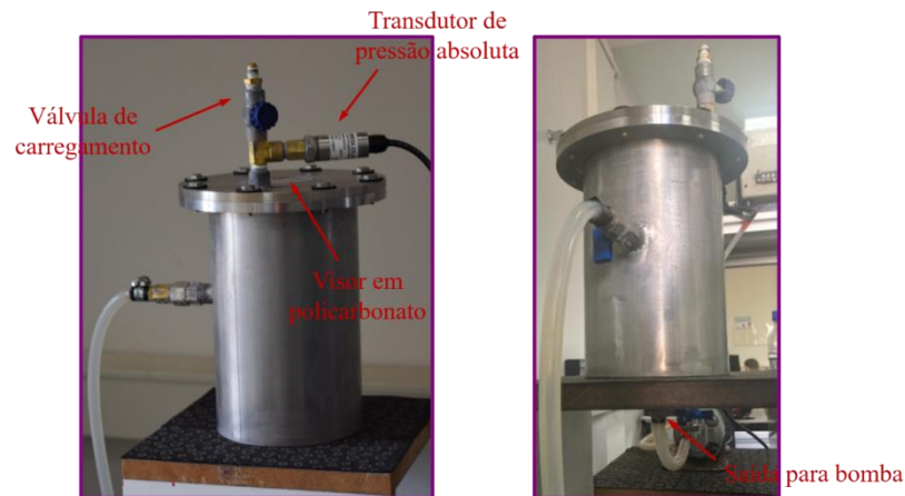
Figura 13 - Reservatório do fluido de trabalho
