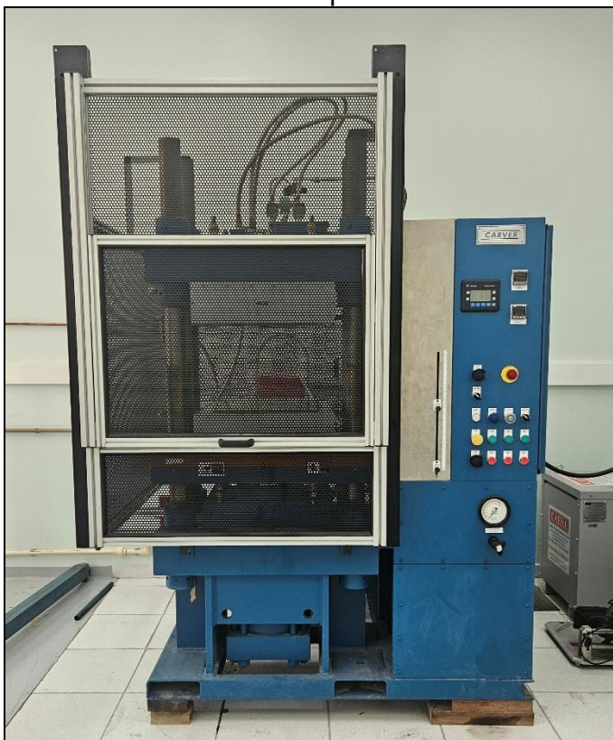
Figura 16 - Prensa hidráulica utilizada no processamento dos compósitos.
