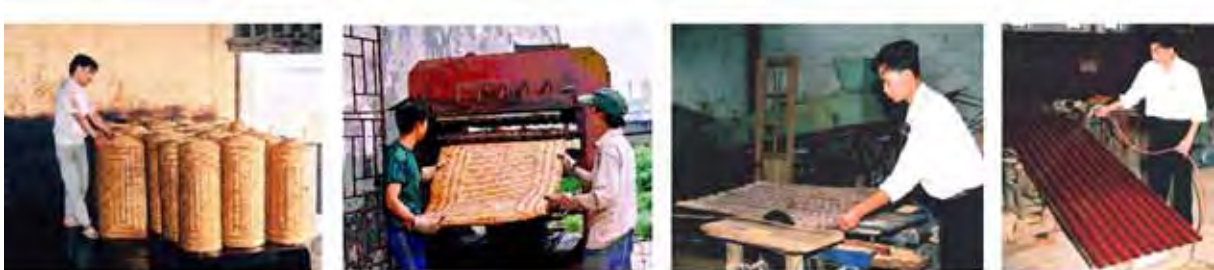
Figura 33. Processo de fabricação do painel ondulado (Fonte: http://www.bamboocomposites.com ).
