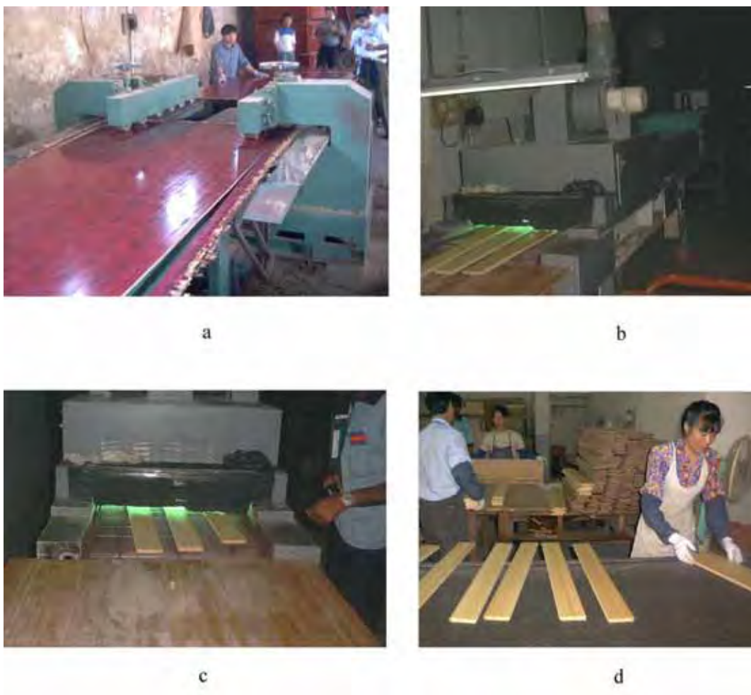
Figura 11. a) painel compensado de bambu; b e c) Pisos de bambu no processo com UV; d) Seleção e controle de qualidade de pisos de bambu (Fotos: MARCO PEREIRA, China, 2000).
