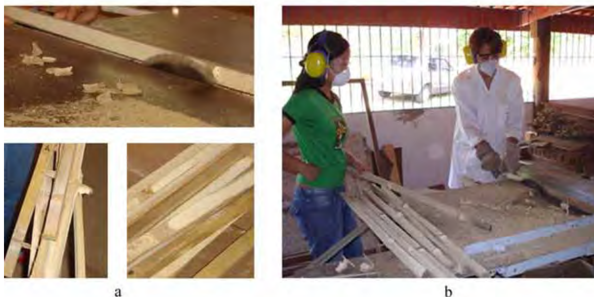
Figura 55. a) Ripas antes e depois da retirada das imperfeições; b) Ripas sendo processadas pelos alunos.
