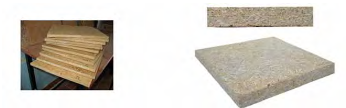
Figura 35. Painei de partículas aglomeradas compostas (SAMPAIO et alii , 2006).
