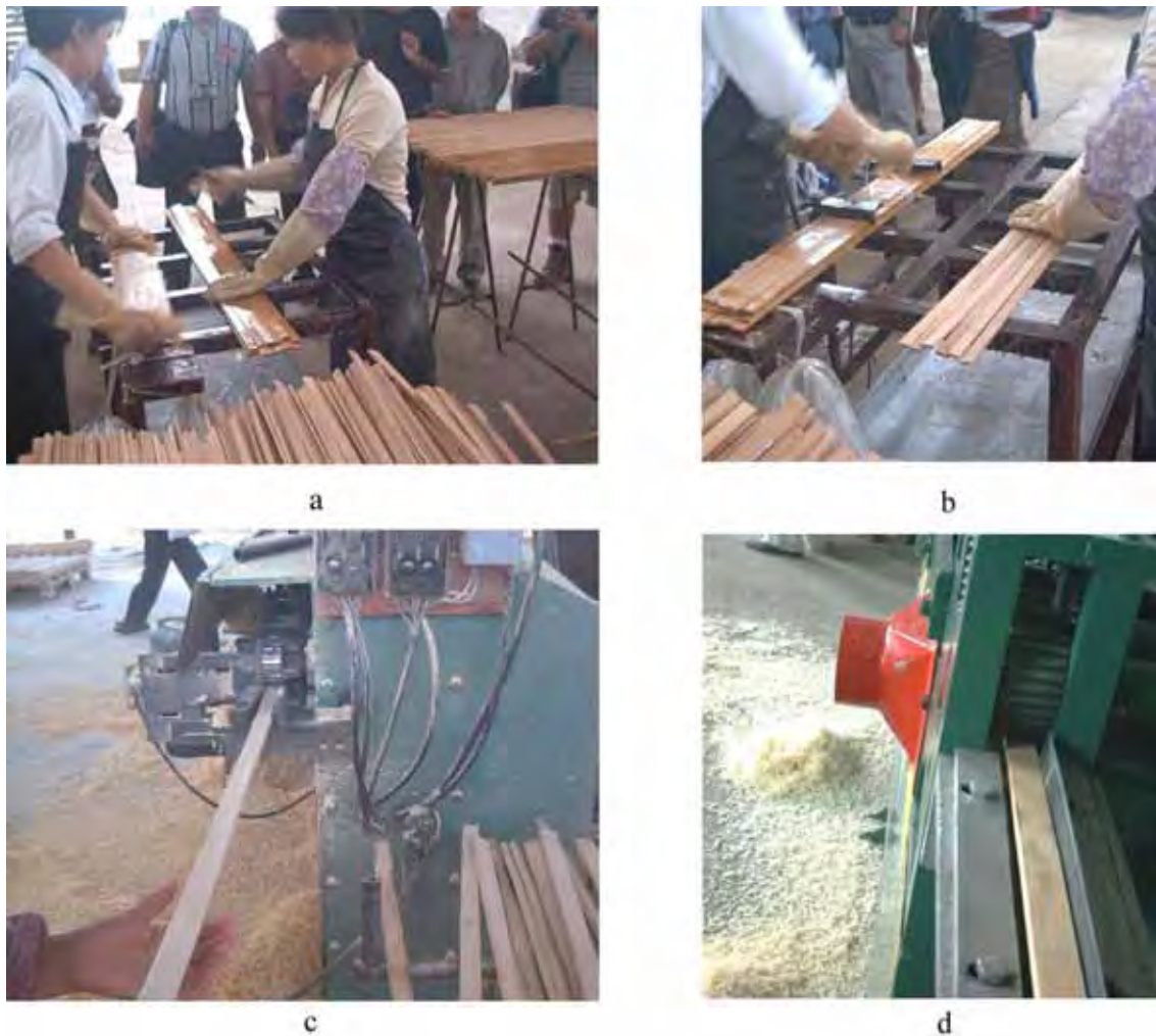
Figura 10. a) e b) Colagem com adesivos; c) e d) Processamento de ripas (Foto: MARCO PEREIRA, China, 2000).
