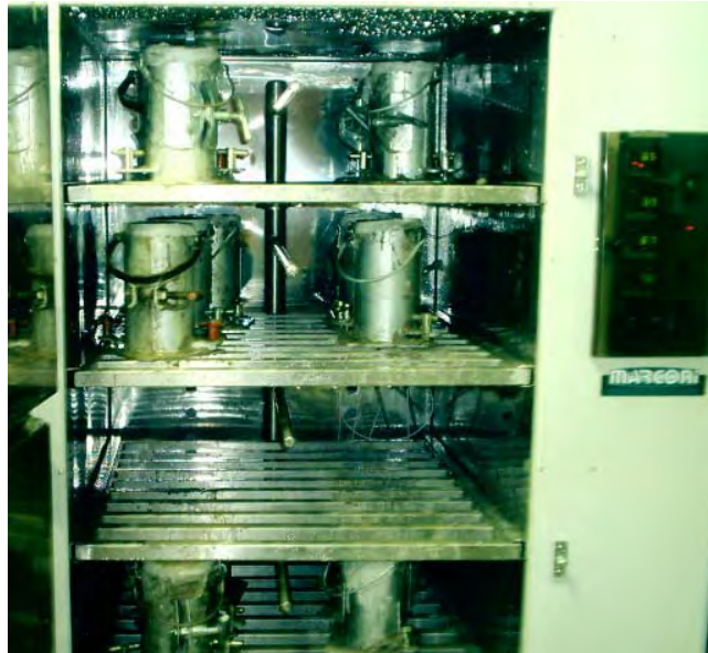
Figura 5.8 – Disposição dos CPs no forno de cura.
