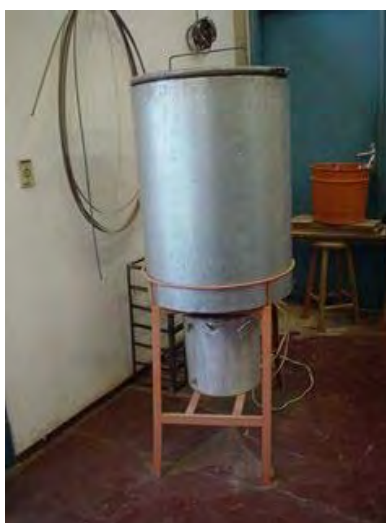
Figura 5.12 – Câmara a vapor.
