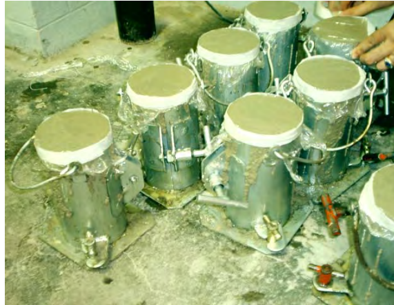
Figura 5.6 - Vedação dos corpos-de-prova
