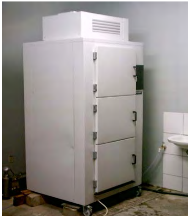
Figura 5.7 - Equipamento de cura térmica.
