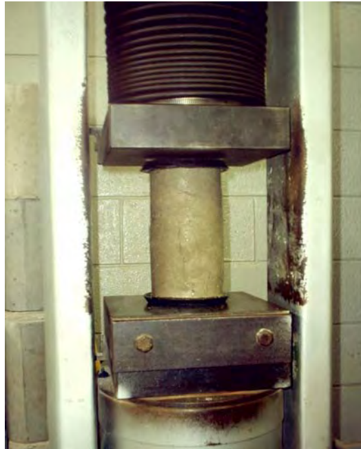
Figura 5.10 - Ensaio de compressão simples.
