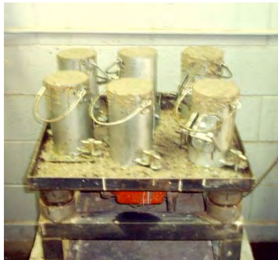
Figura 5.5 – Adensamento dos corpos-de-prova.
