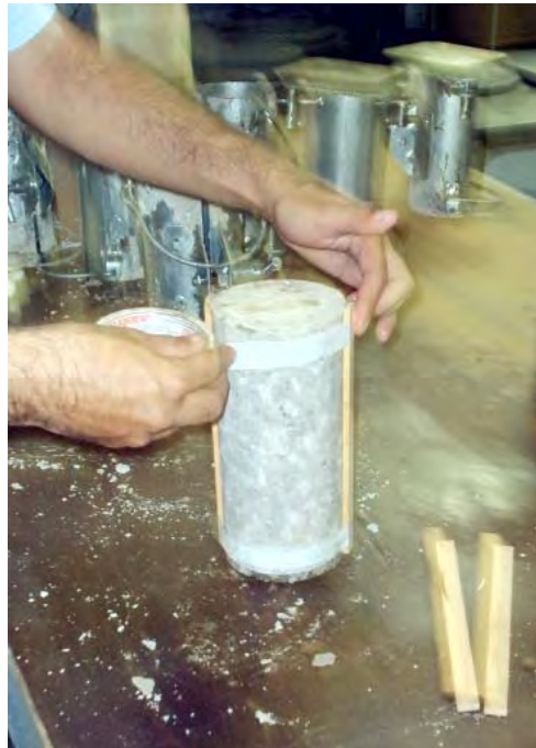
Figura 5.11 – Preparo de CP para ensaio de compressão diametral.
