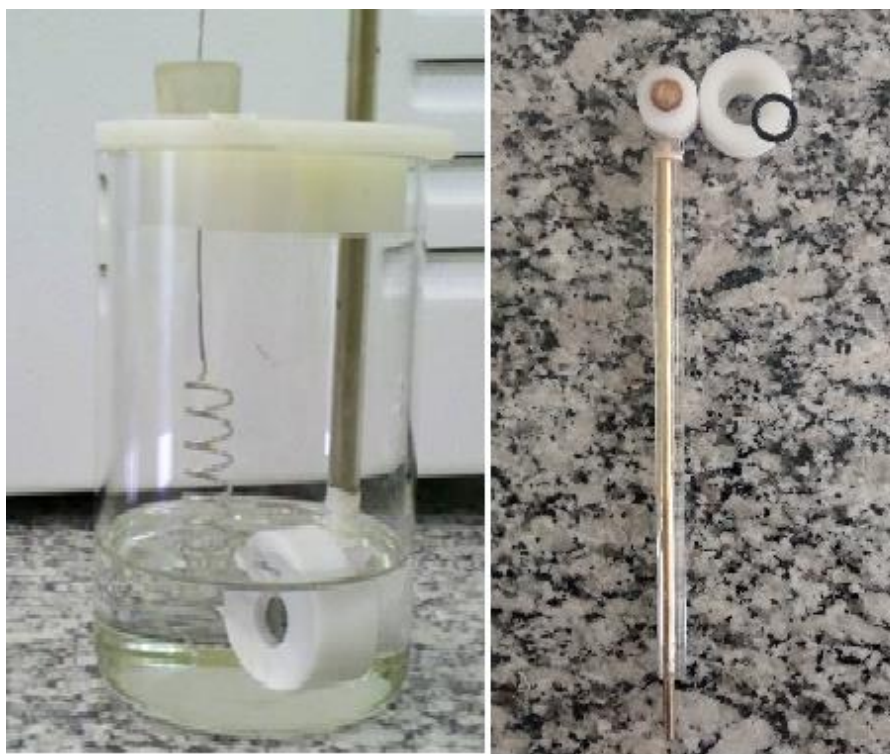
Figura 18 - Amostra na célula de oxidação anódica e porta-amostra utilizado no tratamento
