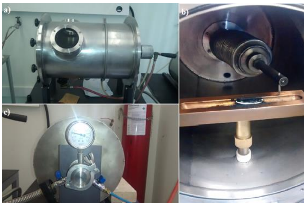
Figura 16 - Forno arco voltaico que foi utilizado na fusão da liga Ti7.5Mo: (a) vista do forno; (b) interior do forno; (c) forno de tratamento térmico
