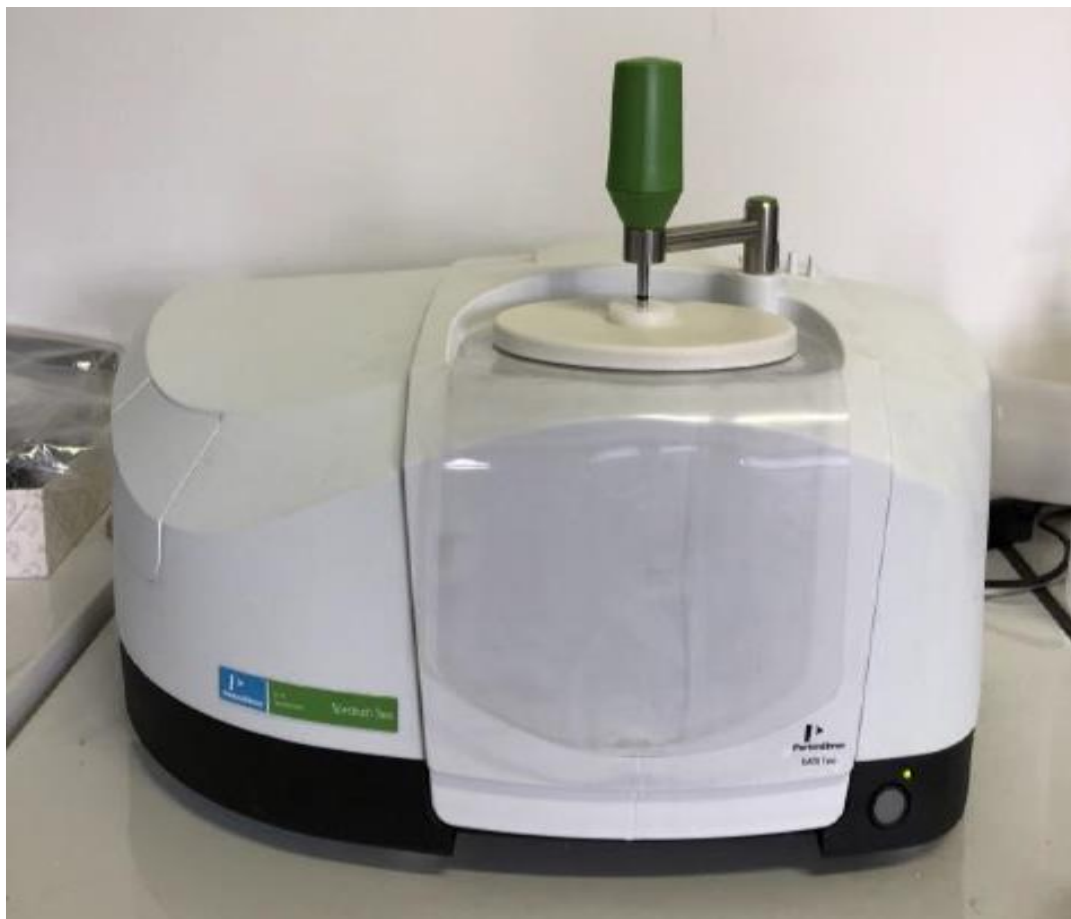
Figura 21 - Espectrômetro utilizado para avaliar o recobrimento polimérico
