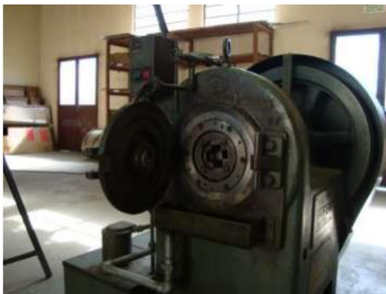
Figura 17 - Forja rotativa utilizada na conformação a frio dos tarugos
