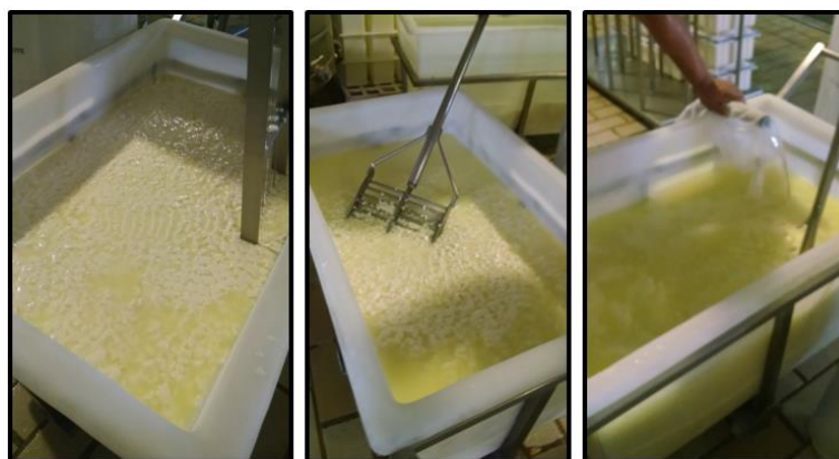
Figura 9: Etapa de corte com a agitação e aquecimento direto, durante o processamento de queijo Parmesão.
