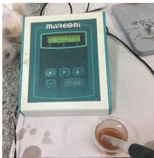
Figura 15 – Peagômetro de bancada utilizado nos ensaios.
