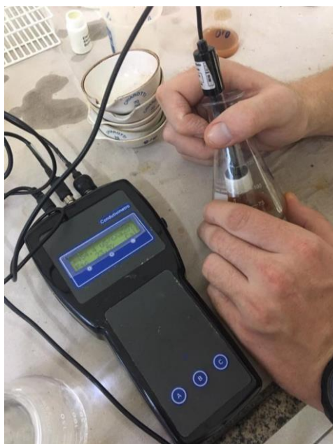
Figura 14 – Condutímetro microprocessado portátil utilizados nos ensaios.
