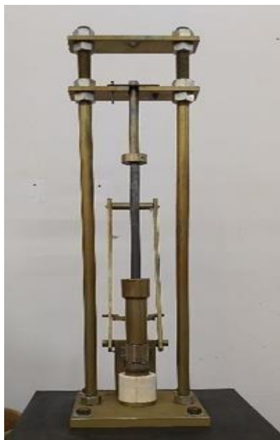
Figura 10 – Compactador utilizado na moldagem dos corpos de prova.
