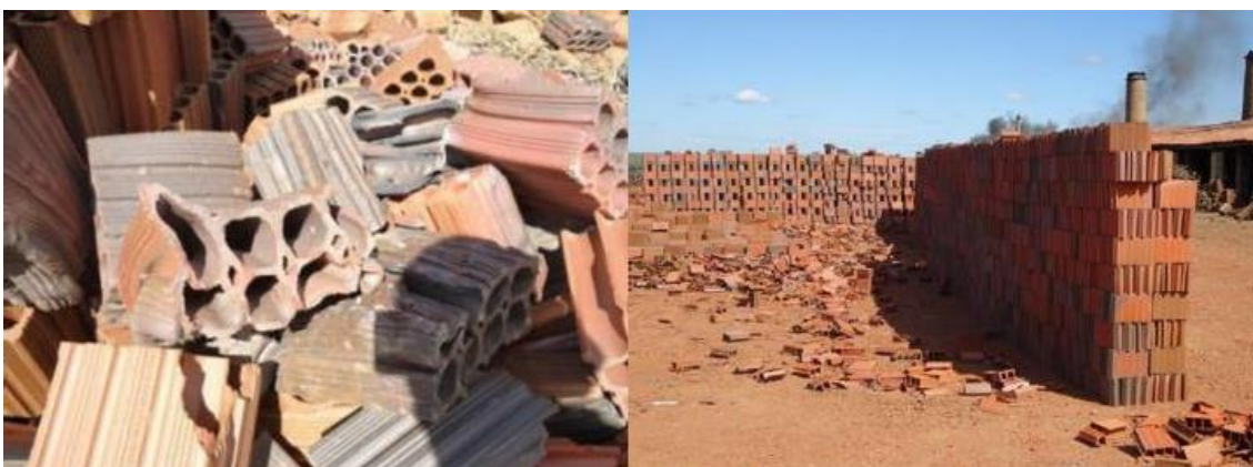
Figura 5 – Exemplos de resíduos gerados pelo setor da Cerâmica Vermelha.
