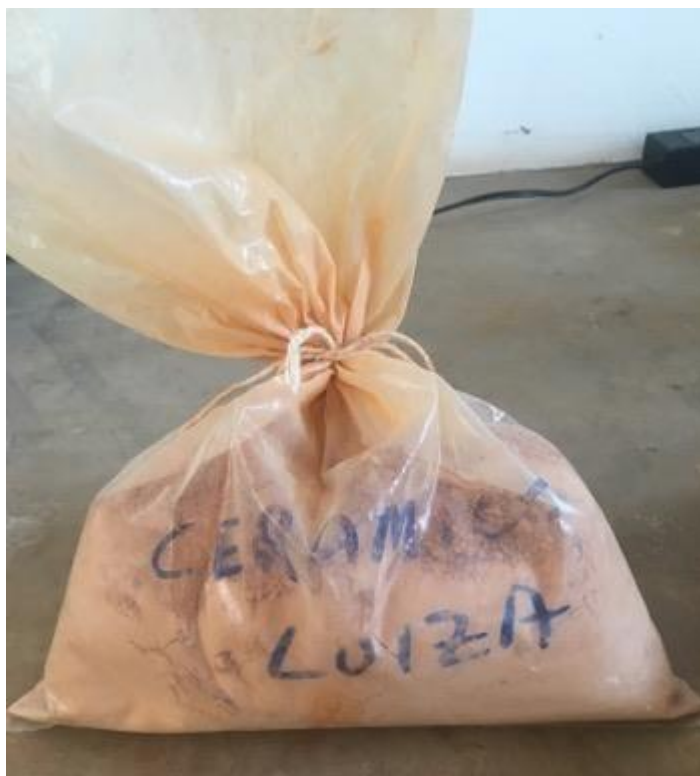
Figura 8 – Resíduo cerâmico utilizado neste estudo após processo de moagem.
