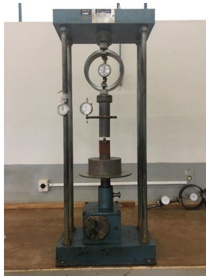
Figura 12 - Prensa de CBR utilizada para o ensaio de resistência à compressão axial.
