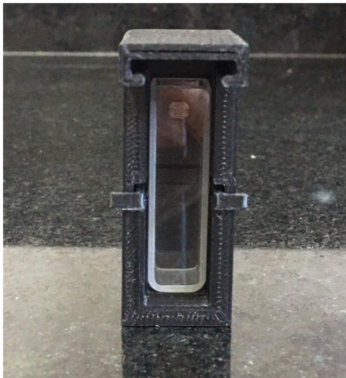
Figura 3 – Cubeta acomodada no suporte para análise de Nitrato
