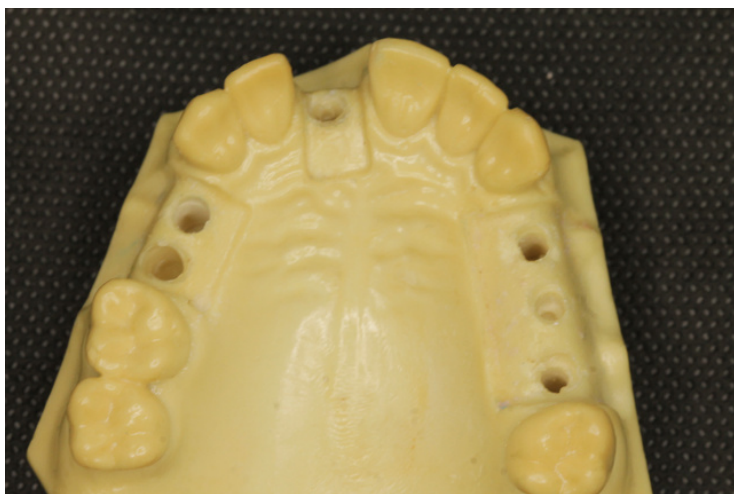
Figura 5 – Modelo de poliuretano (NACIONAL OSSOS) com orifícios realizados nos respectivos locais dos implantes.
