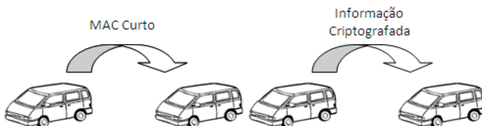
Figura 3 - Representação do envio do MAC curto e em seguida a informação para o receptor no TESLA++.
