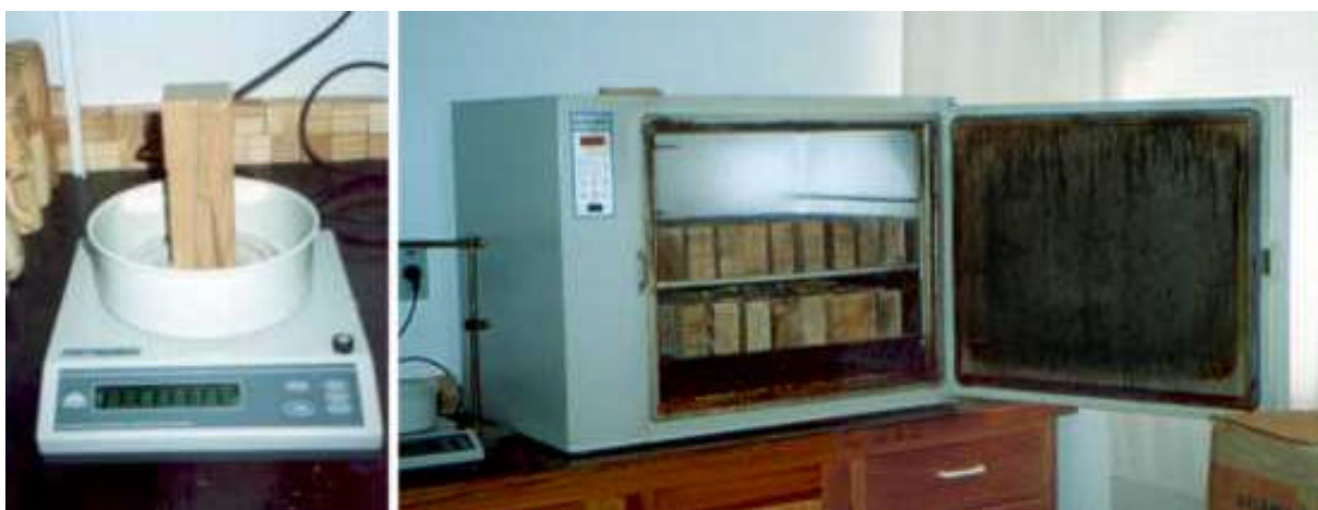
Figura 29 – Pesagem e secagem dos corpos-de-prova.
