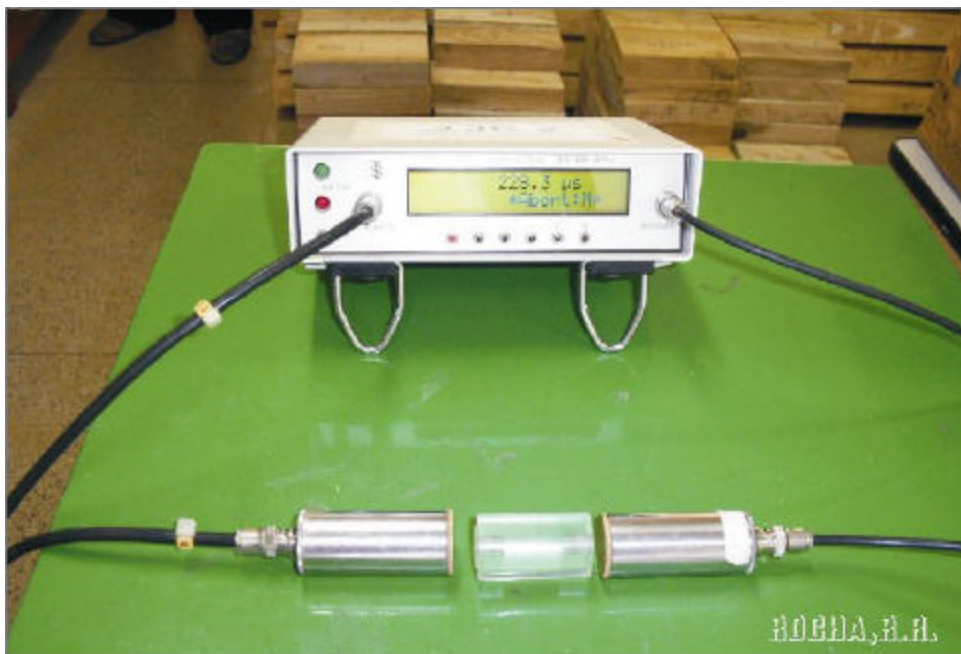
Figura 24-Utilização do calibrador de acrílico (“plexi-glass”) para a calibração do aparelho de ultra-som.
