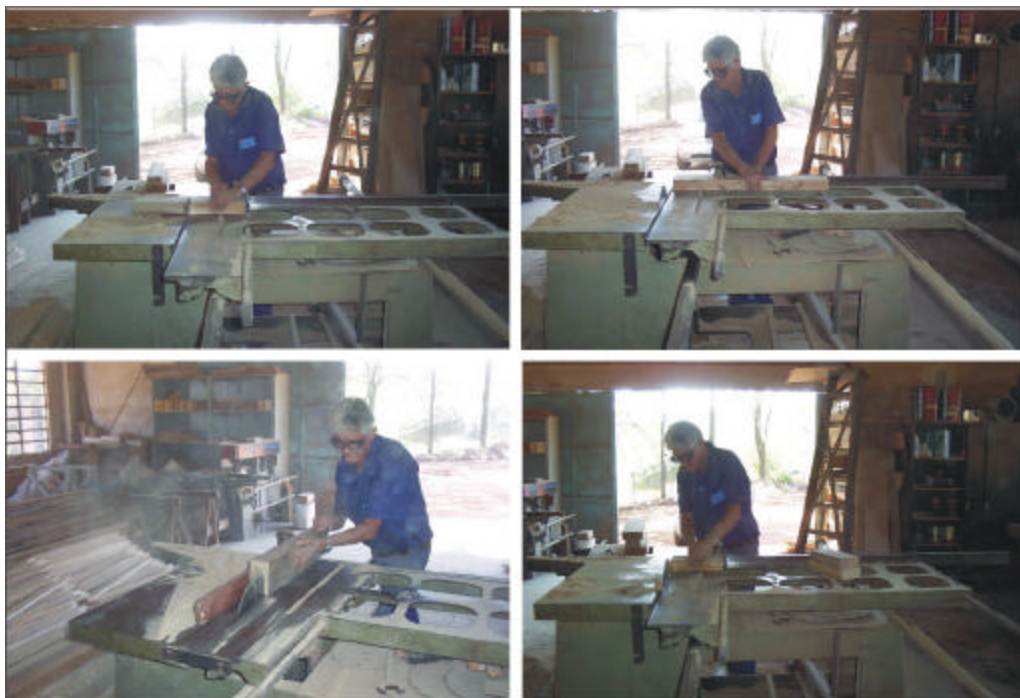
Figura 22 – Operações executadas no desdobro do dormente na serraria da Faculdade de Ciências Agrônômicas do Campus da FCA -UNESP – Botucatu.
