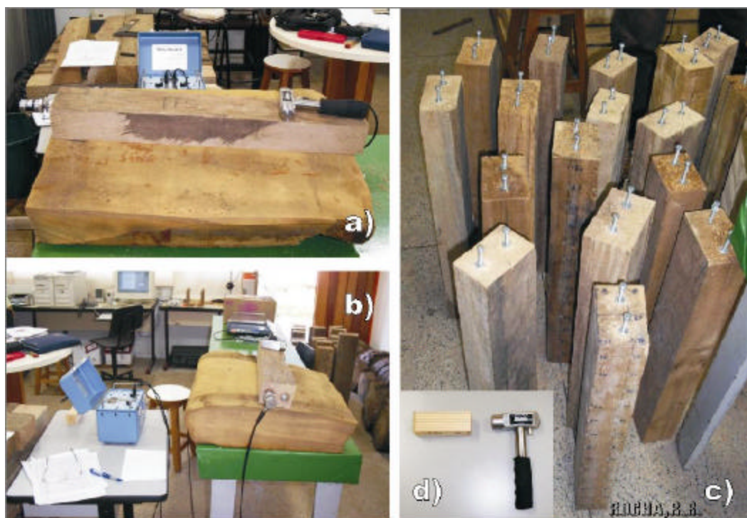
Figura 23 – Ensaio com ondas de tensão: a) vista geral do aparato do ensaio; b) detalhe do transdutor de recepção e do contador de tempo; c) detalhes dos dois pontos de medição no segmento e d) detalhe do martelo.
