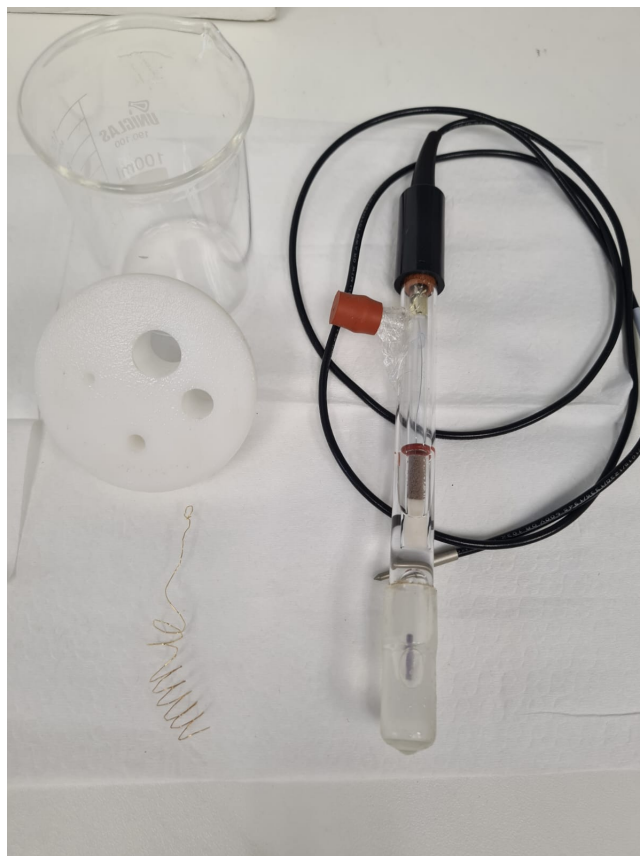
Figura 25 – Célula eletroquímica, contraeletrodo e eletrodo de referência.
